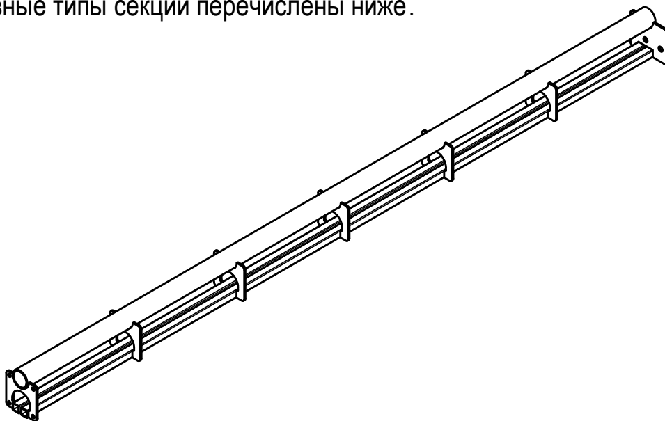
Рисунок 1 - Секция дороги занавеса концевая, L=2 м (масса 14,08 кг)
